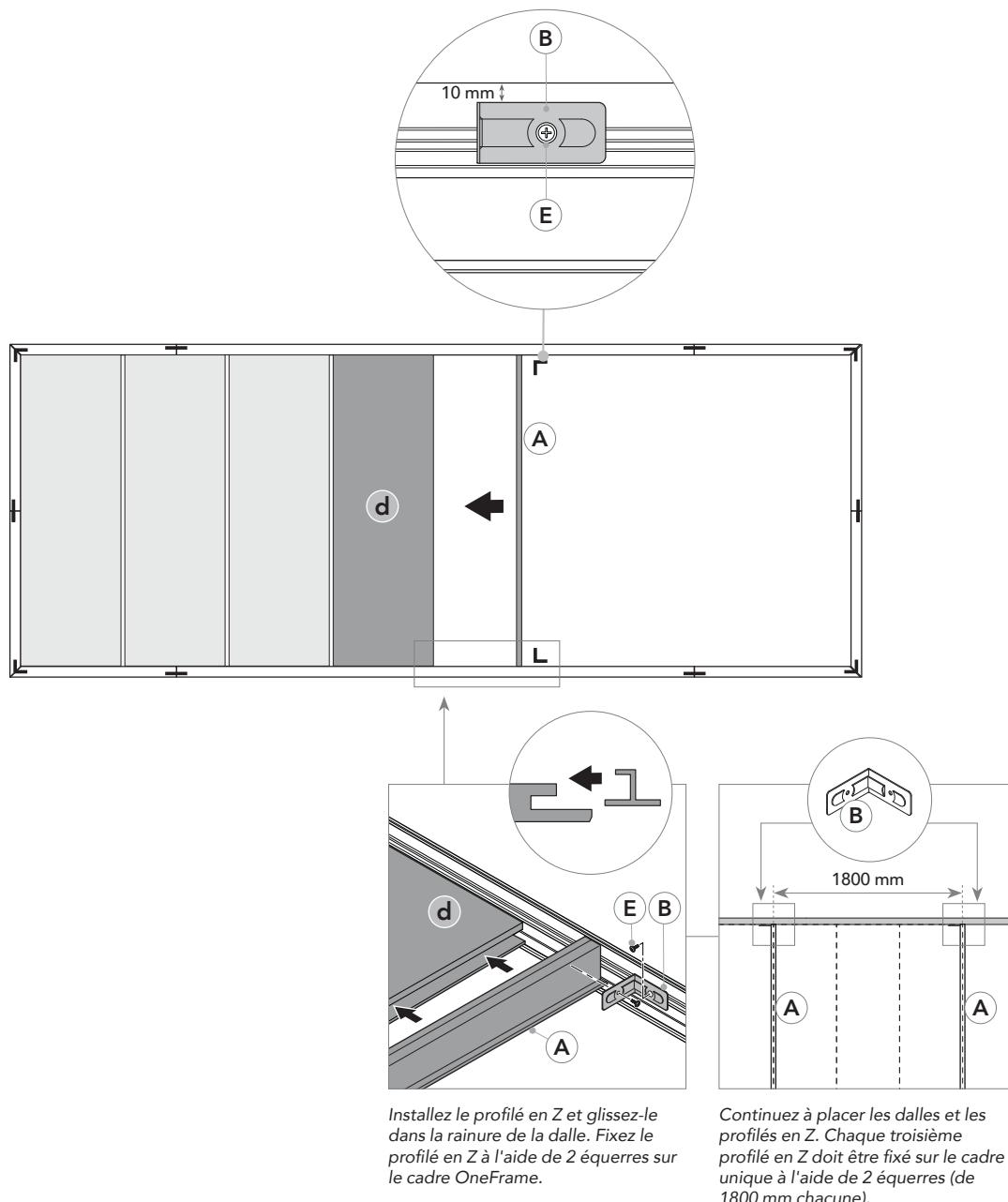
Installez le profilé en Z et glissez-le dans la rainure de la dalle. Fixez le profilé en Z à l'aide de 2 équerres sur le cadre OneFrame.
