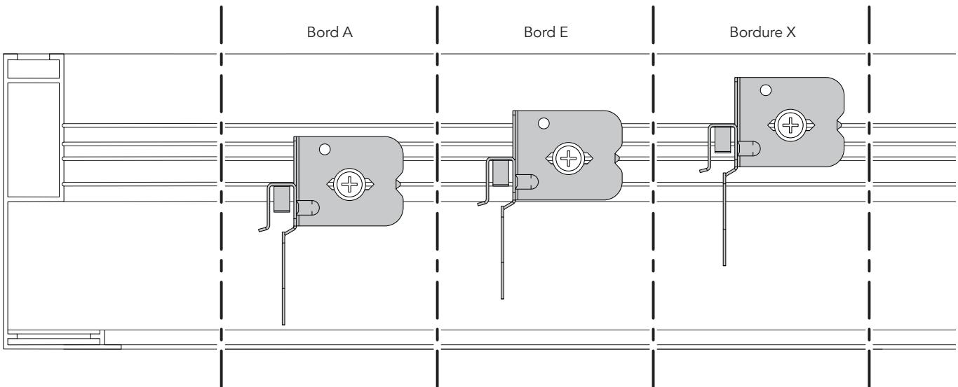
**5** Installez les clips d'ossature OneFrame sur le kit d'angle OneFrame.
